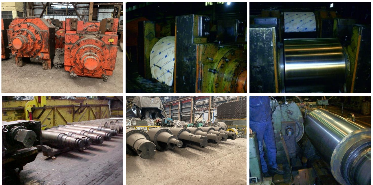
Fig.9: Rodillos, descansos y rectificado de rodillos de respaldo y trabajo.
